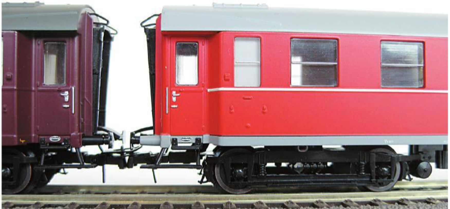
Kortkoblinger kan monteres i stedet for de klassiske A-koblinger, som er monteret fra fabrikken.
