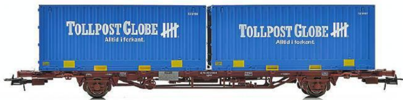
CargoNet Lgns med TOLL-POST containere med ende- og sidedør.
