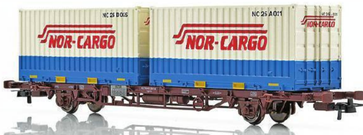
CargoNet Lgns med to 23 fods Nor-Cargo containere.
