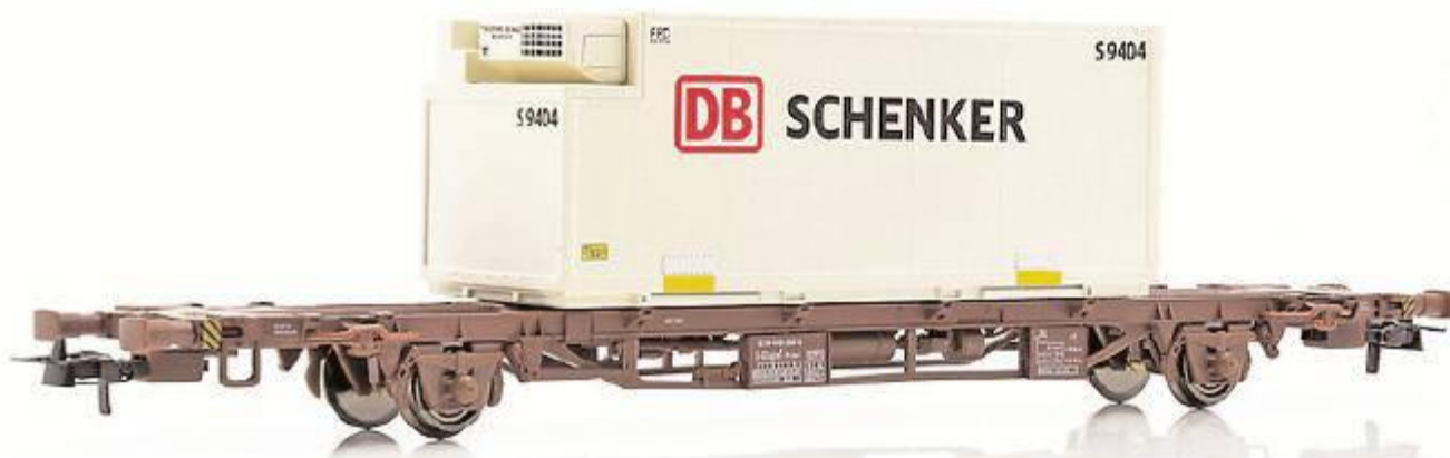
SJ Lgjs med 25 fods kølecontainer med Thermoking aggregat.
